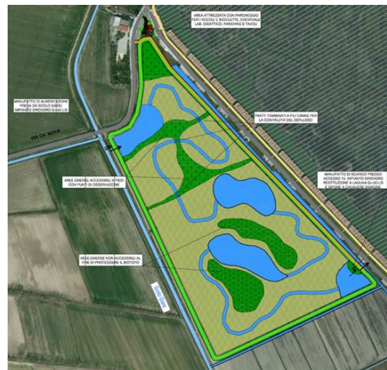
Bacino di fitodepurazione sulle rete di bonifica afferente all'area prelagunare di Giare Consorzio di Bonifica Acque Risorgive
